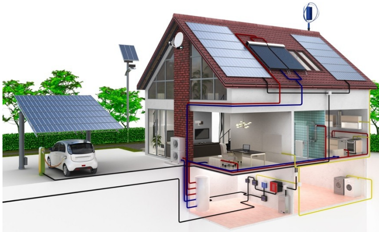
Schema einer Photovoltaik- und Solarthermie-Anlage
